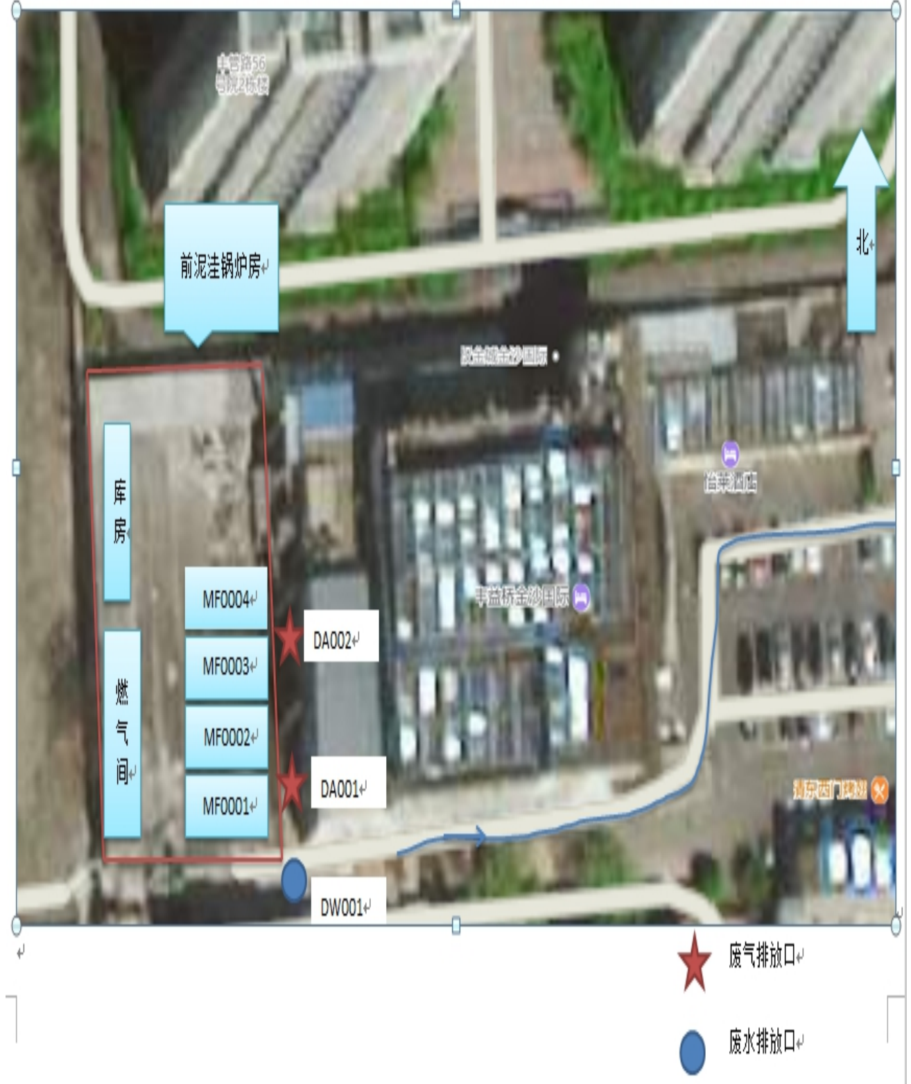
前泥洼锅炉房厂区总平面布置图
